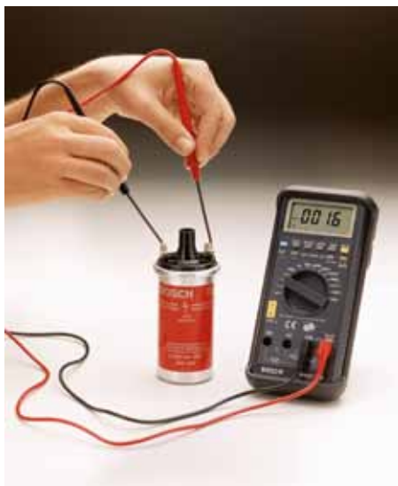
► Medição do enrolamento primário / Medición del bobinado primario
