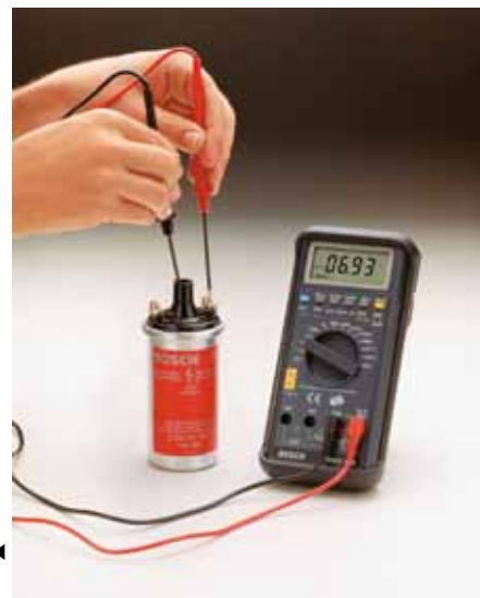
◀ Medição do enrolamento secundário / Medición del bobinado secundario
